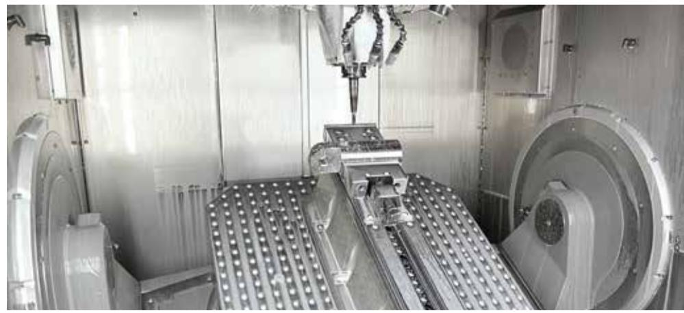
Velký pracovní prostor (1000 x 1100 x 700 mm, X-Y-Z) 5osého obráběcího centra C 50 UP a NC naklápací otočný stůl o průměru 700 mm pro palety o rozměrech 800 x 800 mm pro upnutí obrobků o hmotnosti až 2000 kg.
