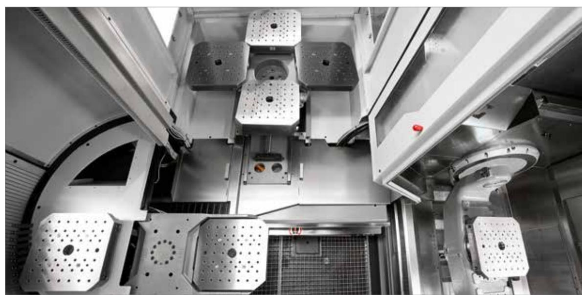
Pohled do výměníku palet PW 250 s osazovacím stanovištěm (vlevo), 4násobným zásobníkem (vzadu), pojížděcí jednotkou (vpředu) a do pracovního prostoru stroje (vpravo).
